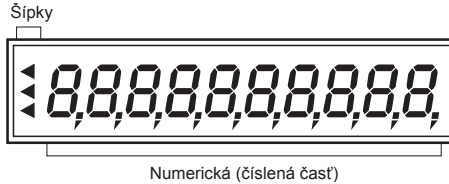
Obrázek 2.5 Rozdělení segmentovího LCD displeje.
