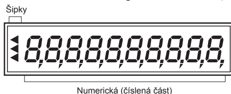
Obrázek 2.7 – Rozdělení segmentového LCD displeje
