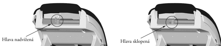
Obrázek 2.8 > Pohled na otevřený střední kryt zezadu (výřez) pokladny Euro-500TE Handy
